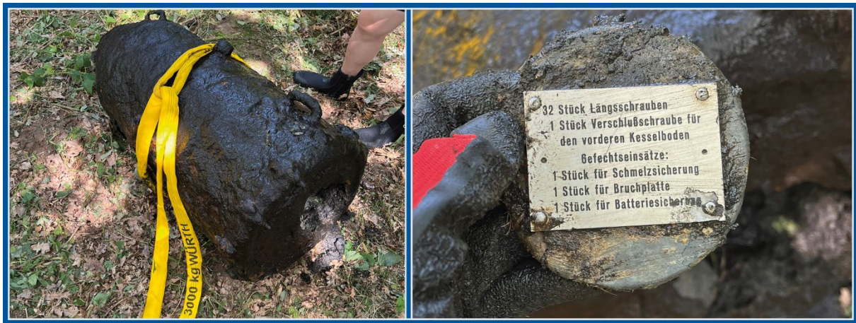
Abbildung 5: Fund in der Schwinge bei Stade: Torpedo G-7 Gefechtskopf, ohne Antrieb (450 kg) und Materialliste zur Herstellung der Gefechtsbereitschaft (Foto: KBD)
