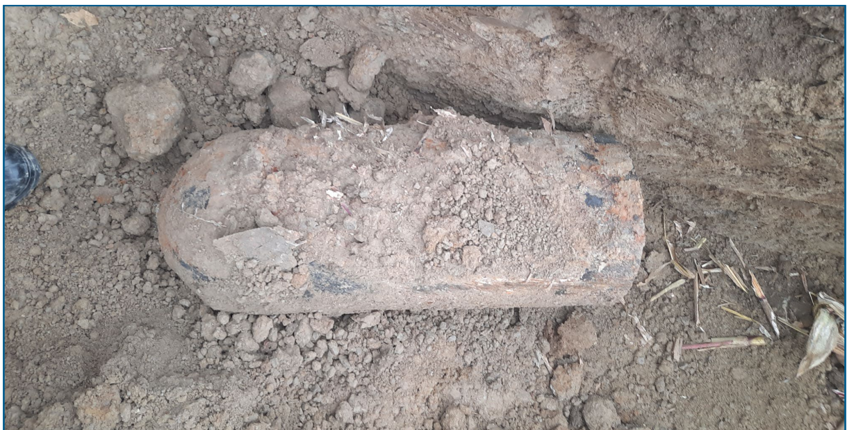
Abbildung 6: Fundmunition, Zielmarkierer (250 lb), Fund in Ackerfläche bei Salzgitter (Foto: KBD)
