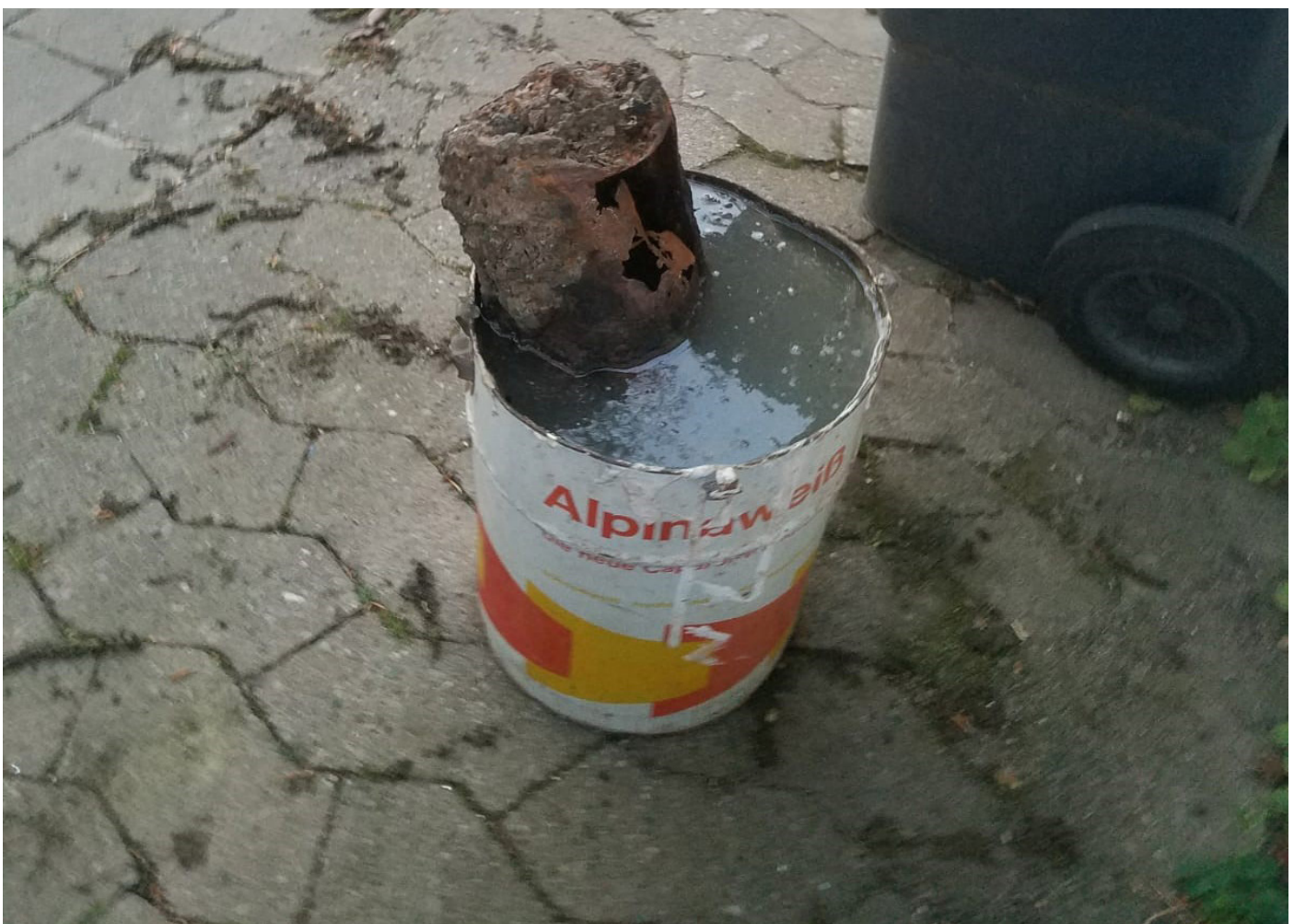
30lb Brandbombe im Wassereimer beim Eintreffen des KBD
