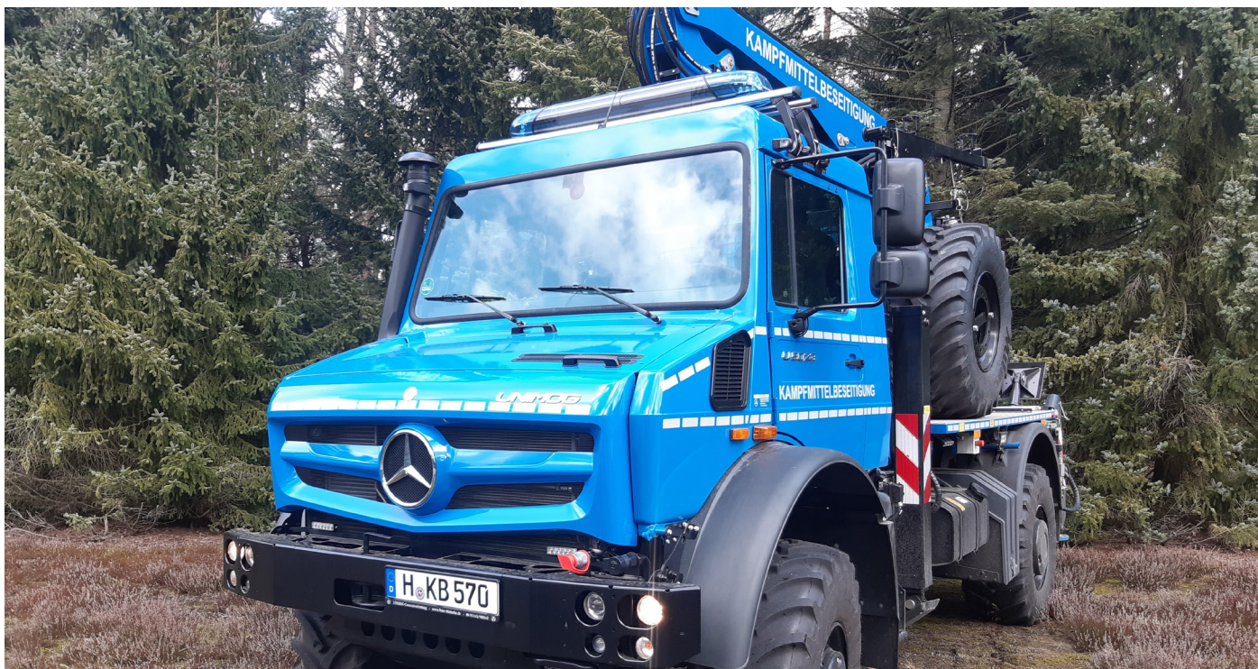
Neuer Unimog U 5023 mit Baggeraufsatz
