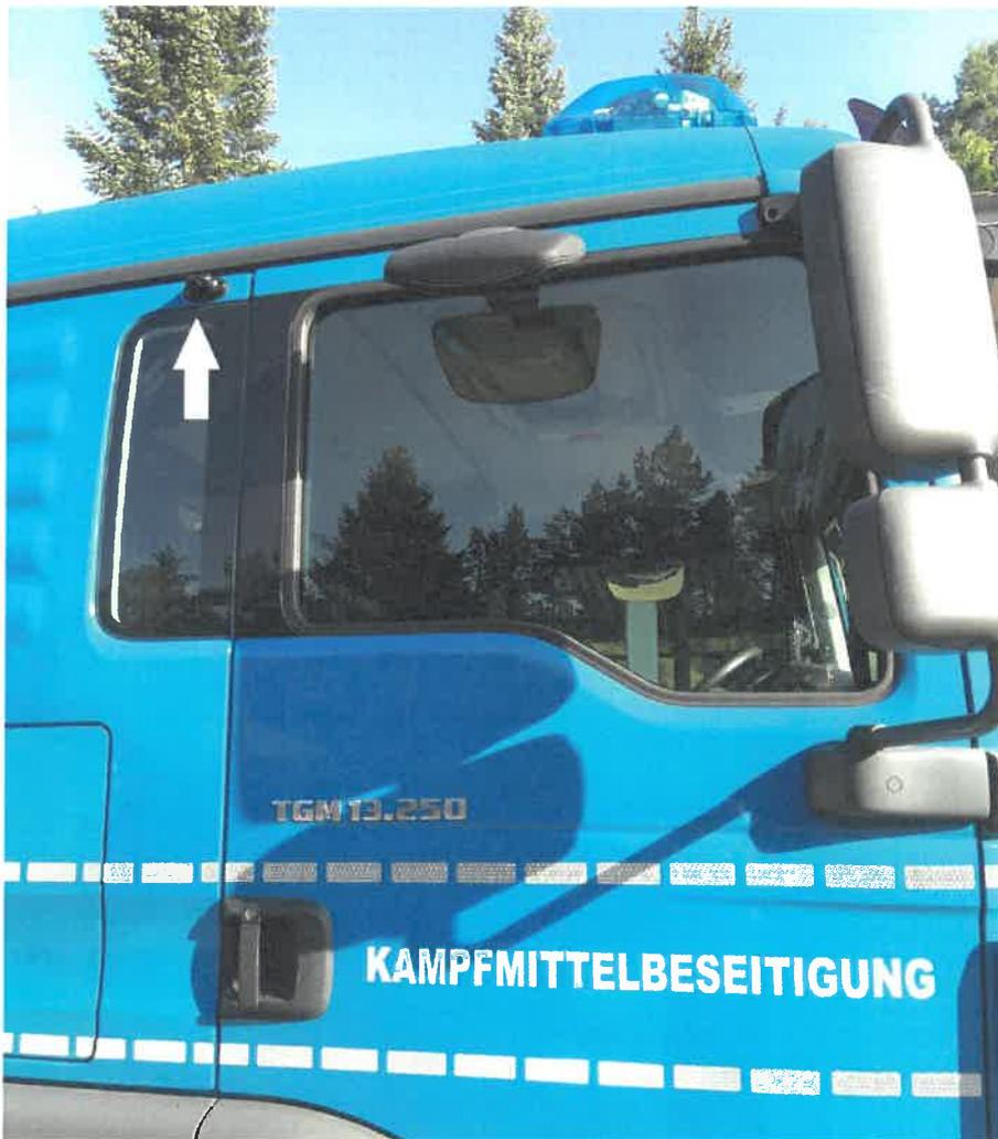
Abb. 12: Kamera für das Abbiegeassistenzsystem
