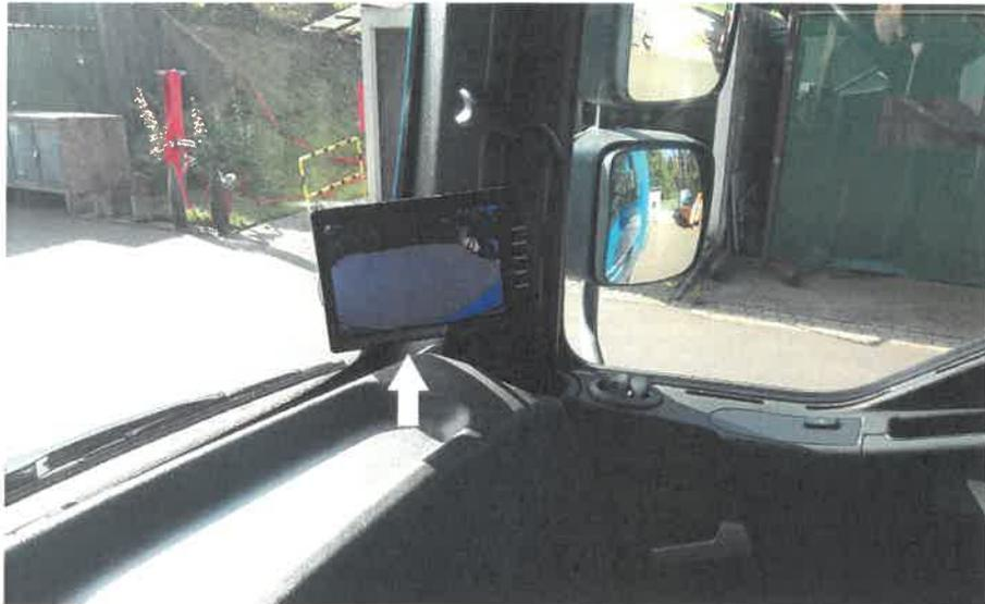
Abb. 13: Monitor für das Abbiegeassistenzsystem
