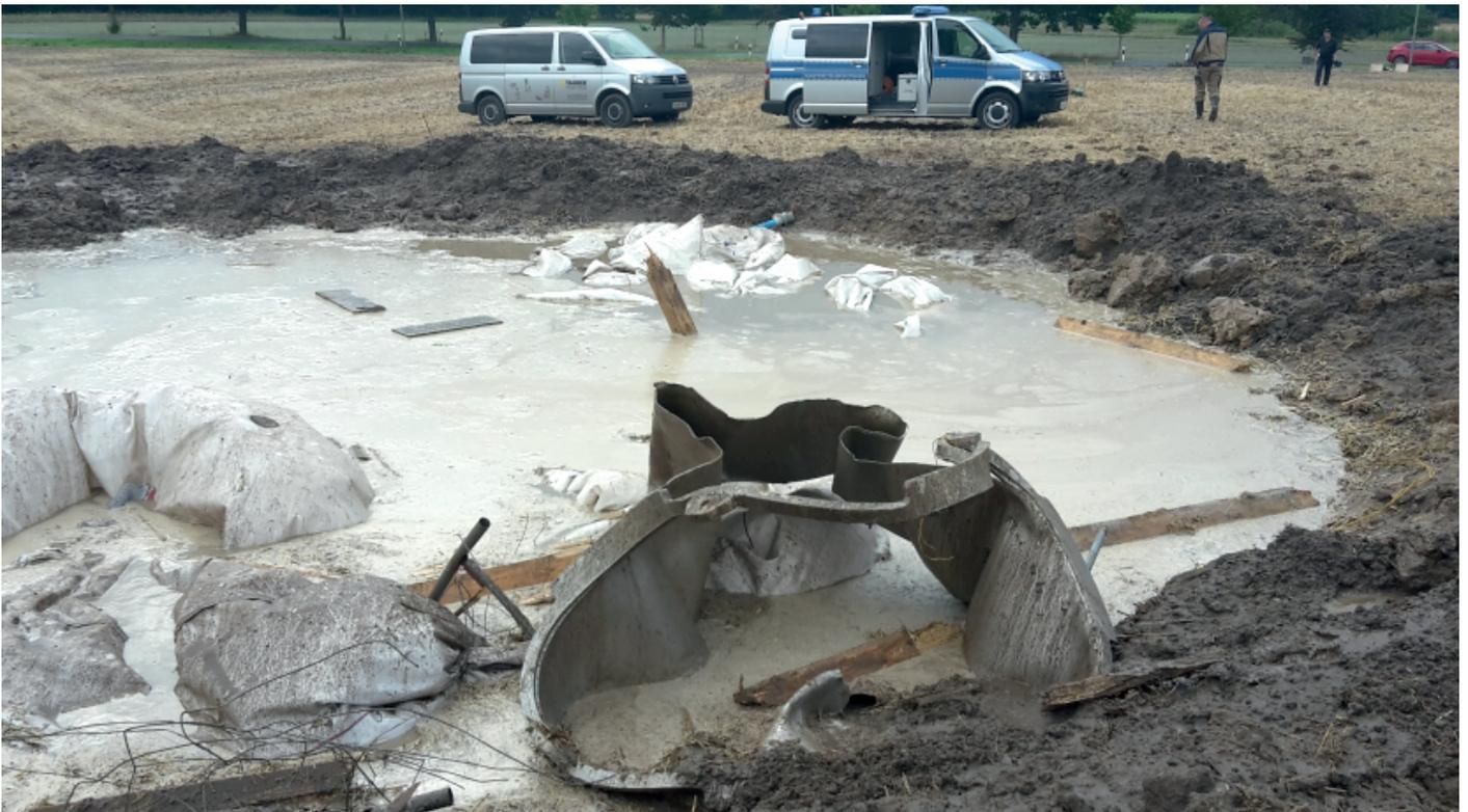
Abb. 3.2: Sprengtrichter nach der Sprengung einer 500lbs Bombe mit beschädigtem Schachtring
