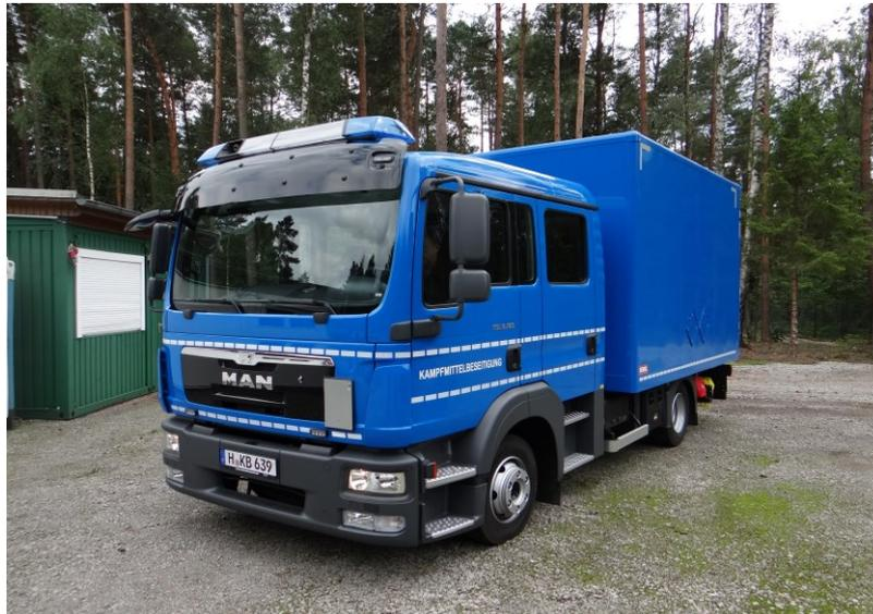
Abb. 4: Munitionstransporter LKW-MAN (7,49t) mit Doppelkabine und der „Schutzklasse EX III“
