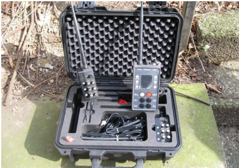
Abb. 3: Ergänzung der Funkzündanlagen der Firma FOG von 4 auf 7 Einsatzeinheiten
